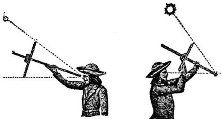
Figura 8. Utilización de la ballestilla, hacia adelante y hacia atrás [Rey Pastor, 1951].
