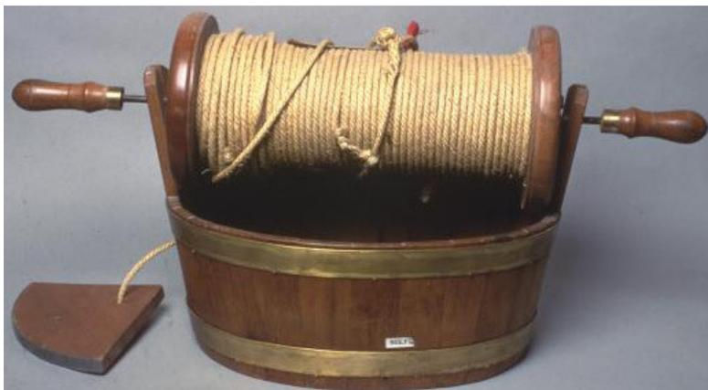
Figura 11. Corredera para medida de la velocidad del barco
