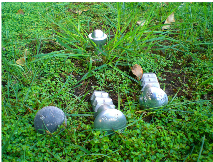
Los “protagonistas”: el clavo viejo, el nodo, el nuevo y la “chica” (señal secundaria).
