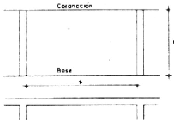
Figura 5.11 - Elemento de muro con arriostramientos transversales
