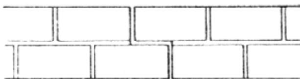
Figura 4.21 - Planta de un solapo en junta de dilatación
