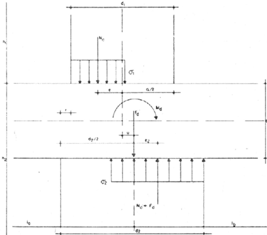
Figura 59- Cargas y tensiones en el empotramiento de un forjado continuo en un muro interno
