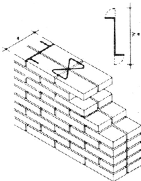
Figura 4.17 - Muro doblado con anclajes
